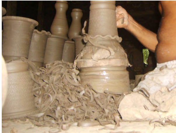
Figura 35: Cavacos gerados pelo acabamento da peça.
