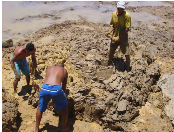
Figura 16: Aprontador pisando e aguando o barro.
