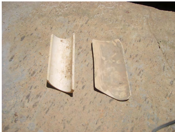
Figura 22: Taquara de PVC utilizada pelos artesãos.
