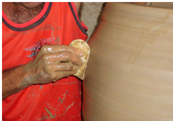
Figura 24: Utilização da taquara durante a modelagem.
