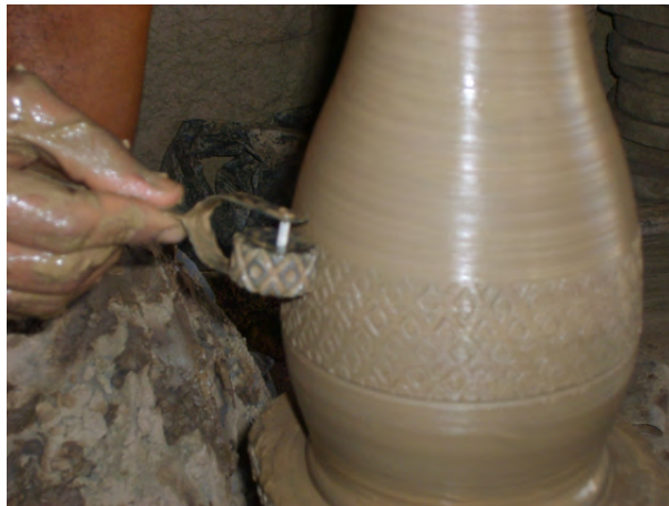
Figura 26: Aplicação de textura com a utilização do carretel.
