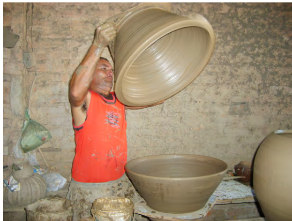
Figura 30: Capilé juntando as duas metades para finalizar a peça.
