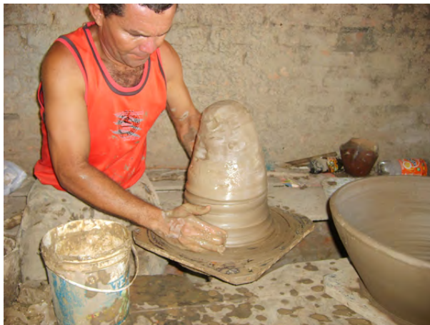
Figura 20: Artesão apoiando bolo de barro sobre o prato.
