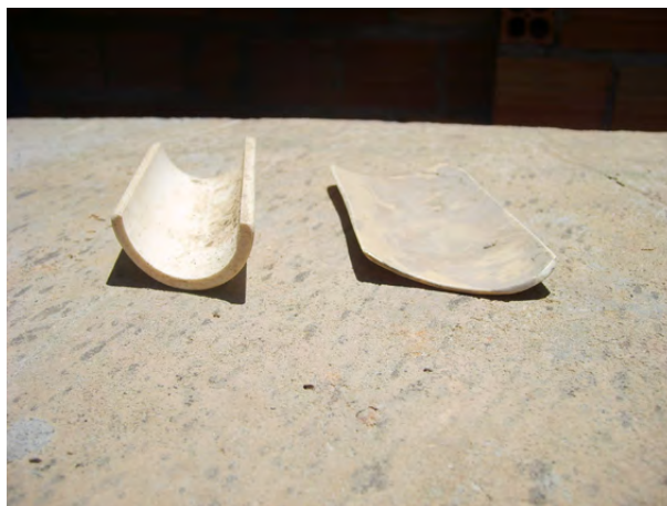
Figura 23: Detalhe da curvatura da taquara de PVC.
