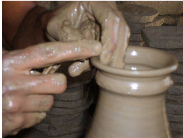
Figura 25: Artesão dando acabamento com a mão na boca da peça.
