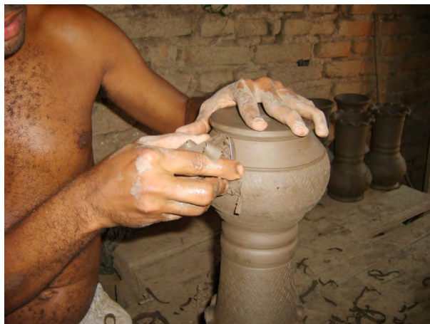
Figura 34: Artesão dando acabamento na peça com a fita.
