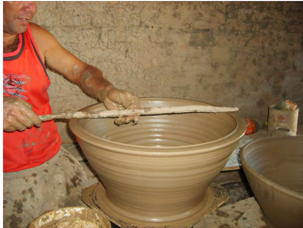
Figura 29: Capilé utilizando a vareta para medir o diâmetro de uma peça.
