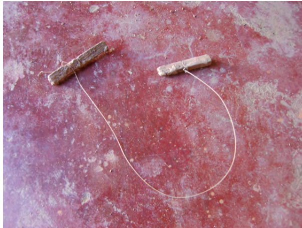
Figura 31: O nylon, ferramenta utilizada para separar a peça do prato.
