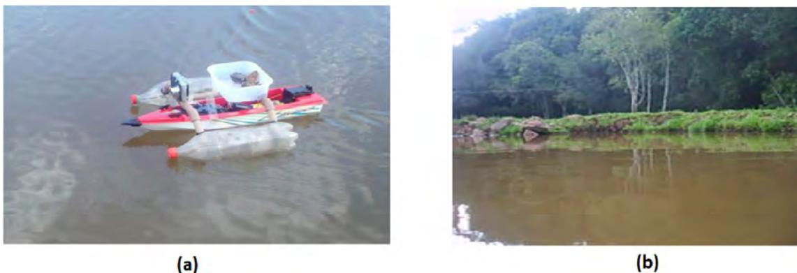
Figura 5.1 – Barco utilizado para a coleta dos dados (a) e um exemplo de imagem coletada do ponto de vista do veículo aquático (b).
