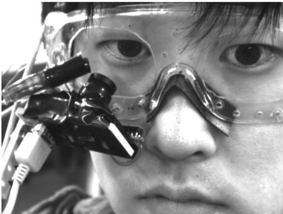
Figura 18 – Vídeo oculografia com iluminação infravermelho e azul Fonte: [34]
