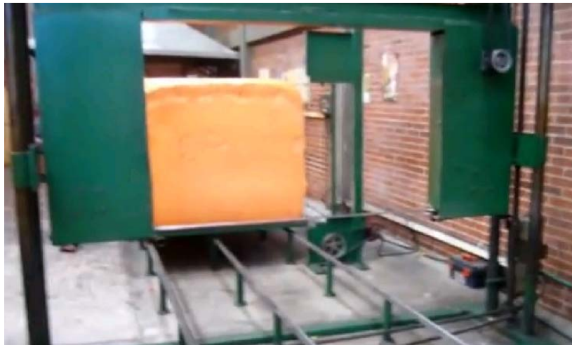
Figura 4.2. Bloco de poliuretano em corte por serra fita horizontal, www.espumamaquinas.com.br
