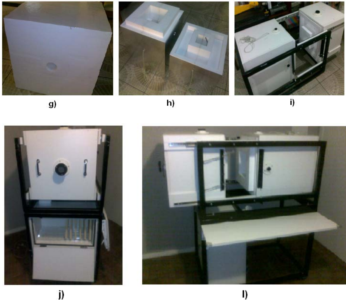
Figura 4.8. Usinagem (a); teste de encaixes no isopor e montagem (b), (c), (d) e (e); envolvimento com película termo retrátil (f), (g) e (h) ; etapas de montagem em (i),(j)e (l)
