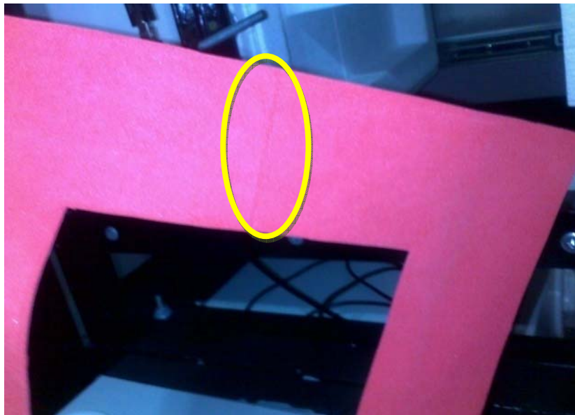
Figura 5.4. Espaçador de EVA mostrando marca da compressão entre as câmaras
