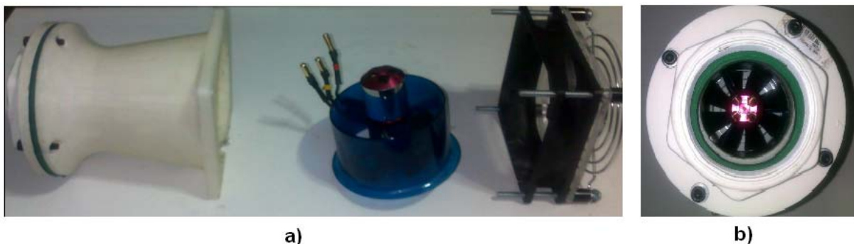
Figura 4.16. Peças para adaptação da turbina
