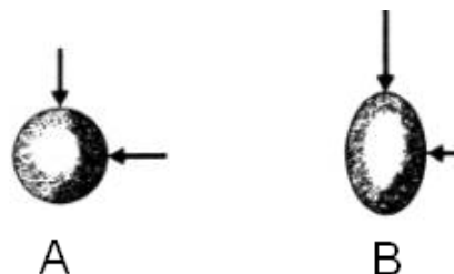
Figura 3.8. Anisotropia da espuma do poliuretano (VILAR,1998)
