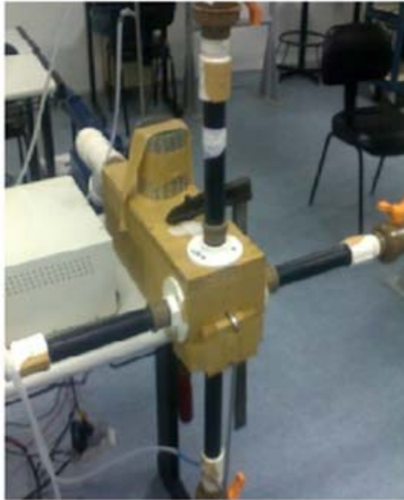
Figura 4.17. Protótipo de desenvolvimento de eletrônica e controle de temperatura e velocidade do ar, com as mesmas condições de volume de ar da câmara da estrutura para experimentos.
