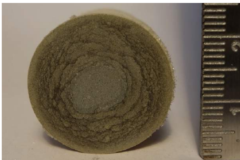
Figura 4.6 – Macrografia da seção transversal de um corpo de prova com 1 % de OMMT submetido por 56 dias ao meio HS.
