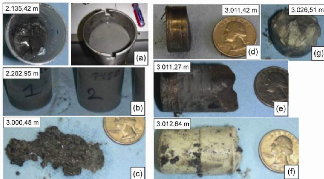
Figura 3.9 – Testemunhos retirados de um poço de 68 anos no campo de Crandfield – EUA. Fonte: Duguid et al. (2014).
