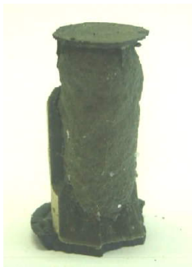
Figura 5.42 – Fotografias de um (a) corpo de prova submetido à ensaio de resistência à compressão e (b) detalhe do desprendimento da camada alterada quimicamente.
