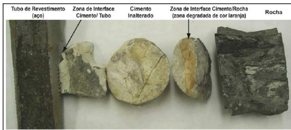
Figura 3.8 – Testemunhos de aço, cimento e rocha do campo de SACROC no Texas – EUA, espessura do anel de pasta de cimento de aproximadamente 50 mm. Adaptado de Carey et al. (2007).
