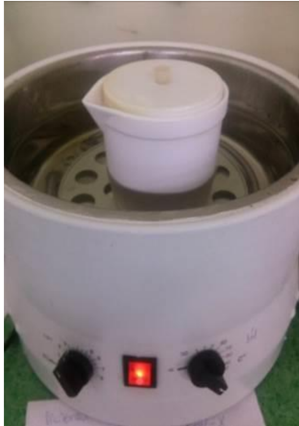
Figura 4.1. Reator de teflon em banho maria contendo glicerina.
