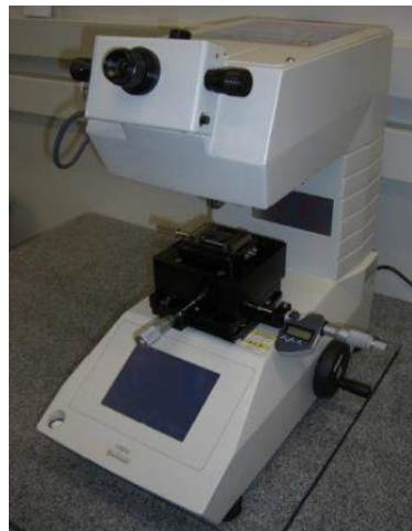
Figura 5.16. Microdurômetro para ensaio Vickers (CEPAC- PUCRS).
