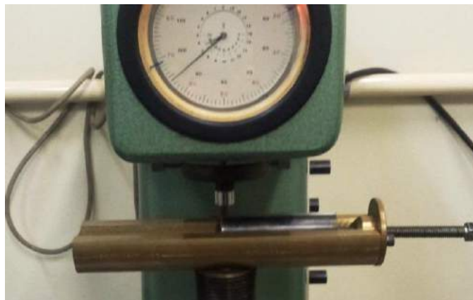
Figura 5.15. Ensaio de Dureza HRC em corpo de prova retificado (LAMETT – PUCRS).
