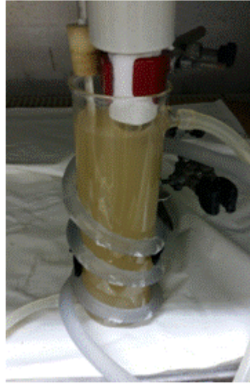
Figura 4.8. Sistema utilizado nos testes de fotodegradação do corante azul de metileno.
