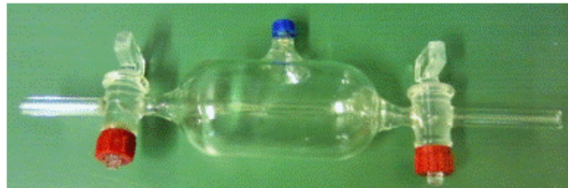
Figura 4.11. Cápsula coletora de vapor de n-butanol gerado no processo dinâmico.
