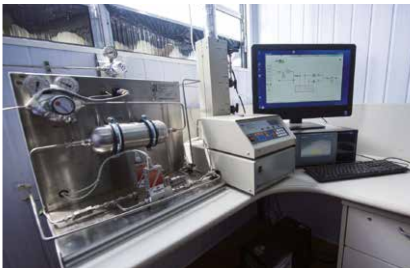
Sistema de injeção de CO 2 automatizado
