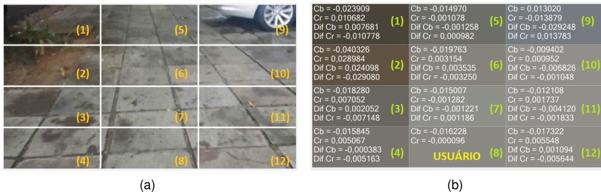
Figura 4.11 – Exemplo de imagem com obstáculos: (a) Imagem dividida em blocos; (b) Características de cores de cada bloco.
