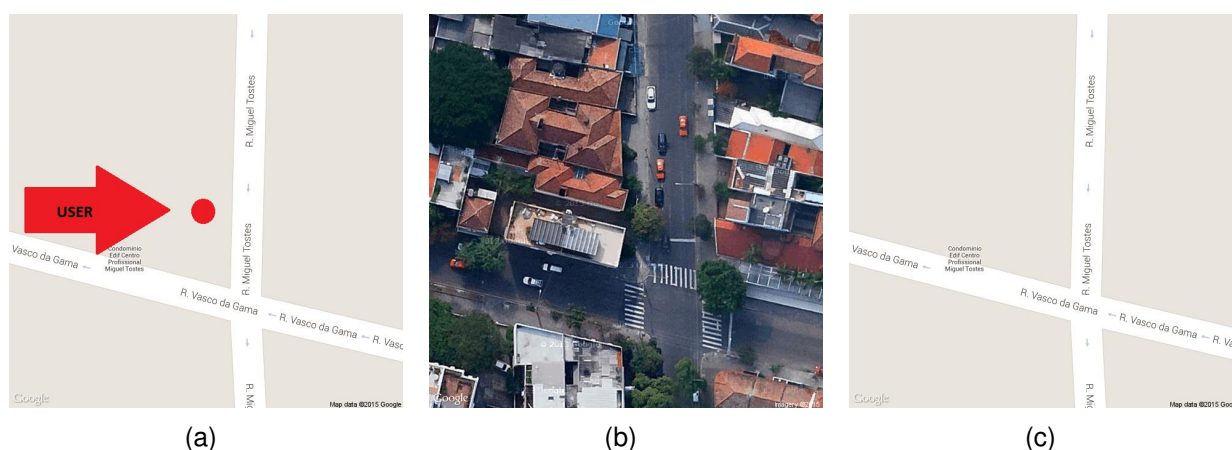
Figura 4.16 – A aquisição das imagens: (a) Coordenadas GPS enviadas pelo usuário, ilustrada pelo ponto vermelho; (b) Imagem de satélite extraída do Google Maps; (c) imagem rodoviária extraída do mesmo conjunto de dados.
