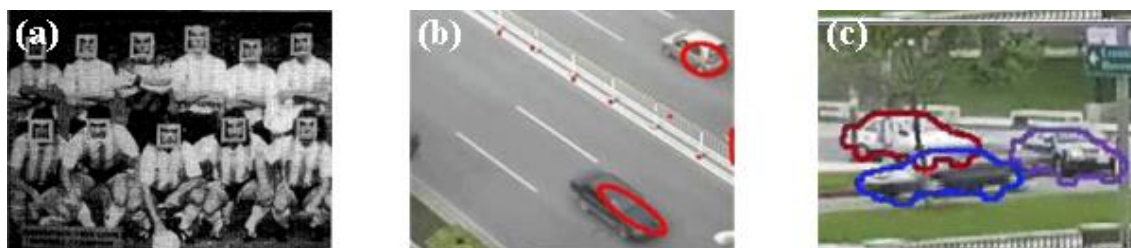
Figura 8 - Exemplos de representação de objetos através de formas geométricas primitivas (a) e (b) e contornos (c).
