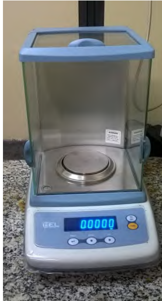
Figura 4.3.3. Balança digital de precisão (0,0001g) utilizada na determinação da gramatura das amostras.
