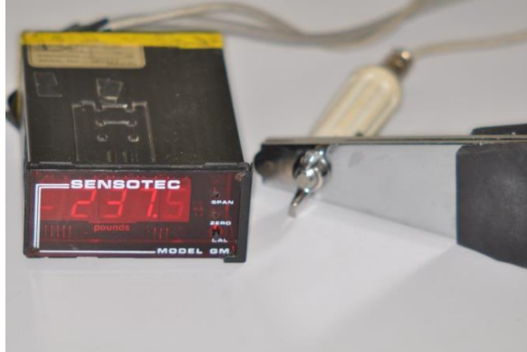
Figura 1 - Aparelho de força máxima de mordida Fonte: Arquivo pessoal
