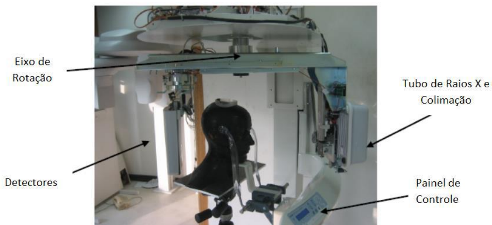
Figura 8 - Ilustração dos componentes internos de um equipamento Cone Beam Fonte: Report n°2008-0748. (30)
