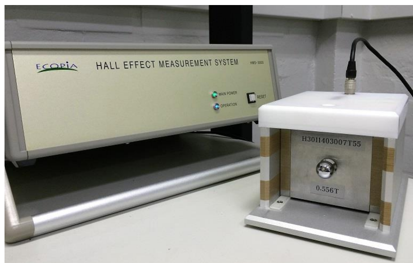
Figura 4.1. Sistema de medição Hall, modelo HMS-3000, Ecopia®.
