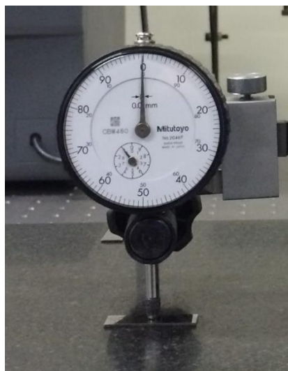
Figura 4.4. Relógio comparador analógico utilizado para medir a espessura das amostras.
