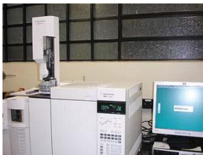
Figura 4.6. Equipamento de cromatografia a gás acoplado à espectrometria de massas (GC/MS).
