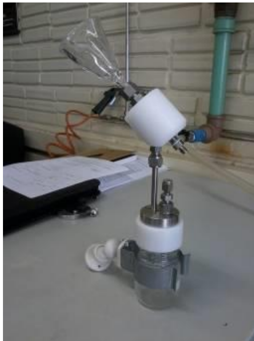
Figura 4.2. Olfatômetro antes da instalação no cromatógrafo.
