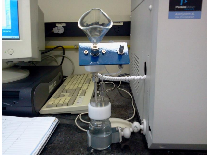
Figura 4.3. Olfatômetro desenvolvido no laboratório acoplado ao cromatógrafo a gás.
