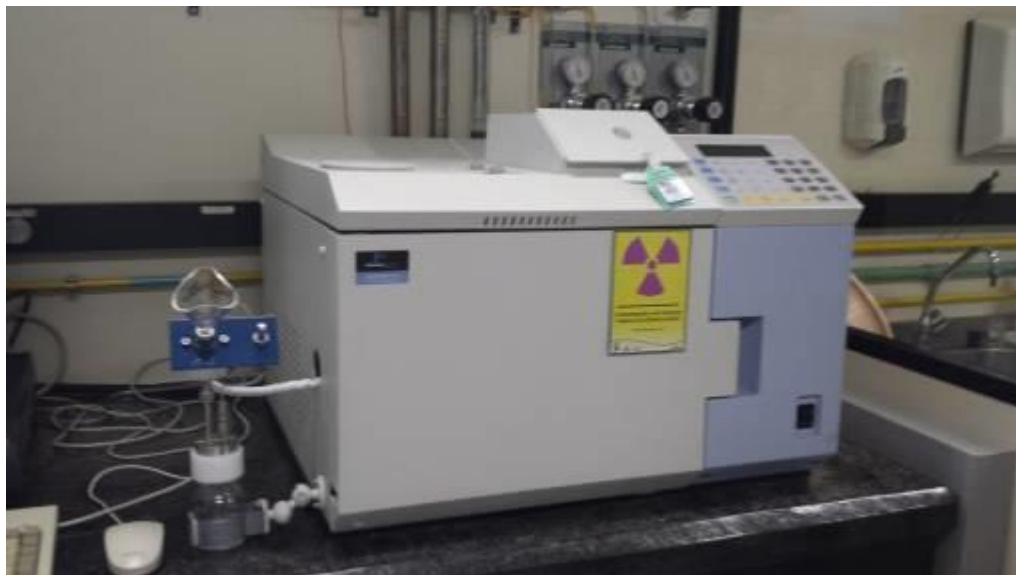
Figura 4.4. Equipamento híbrido (GC/O) para análises olfatométricas.
