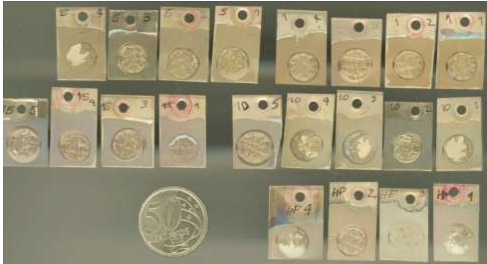
Figura 5.29. Imagem das amostras após os testes de pull out .
