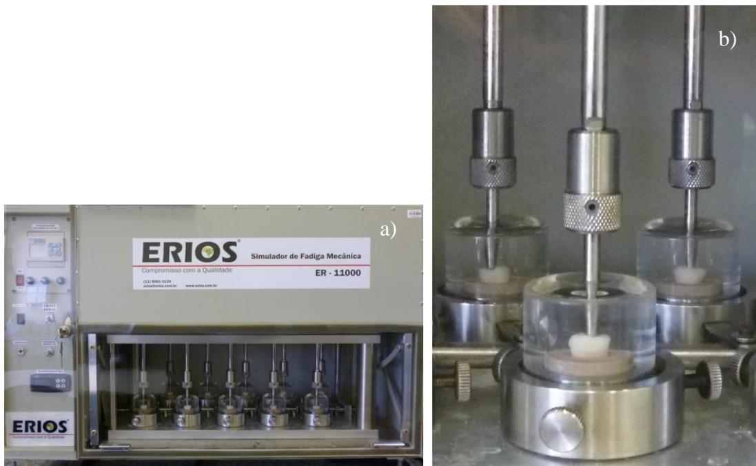
Figura 10: a) Máquina de ensaio universal simuladora de fadiga mecânica; b) Vista aproximada dos corpos de prova na máquina imersos em água destilada.
