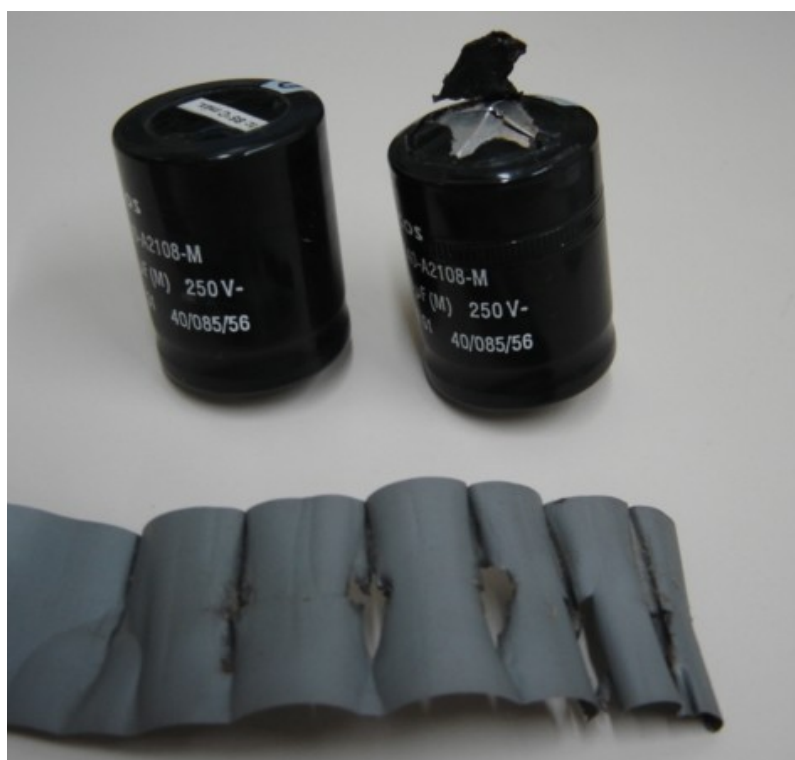
A.2 – Capacitores eletrolíticos que ao receberem tensões acima de sua capacidade, aqueceram acima de 200 graus Celsius e romperam gradativamente seu isolamento interno
