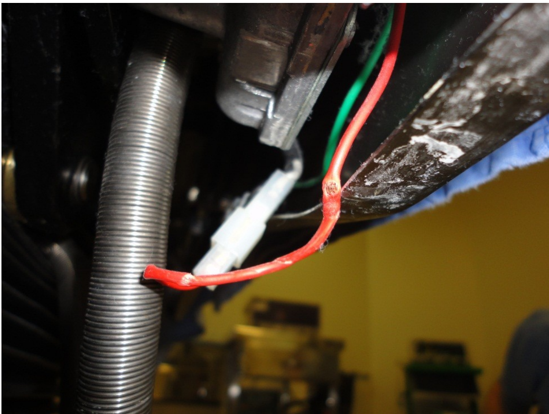
A.3 – Parte de um condutor de uma mesa de cirurgia que foi prensado.
