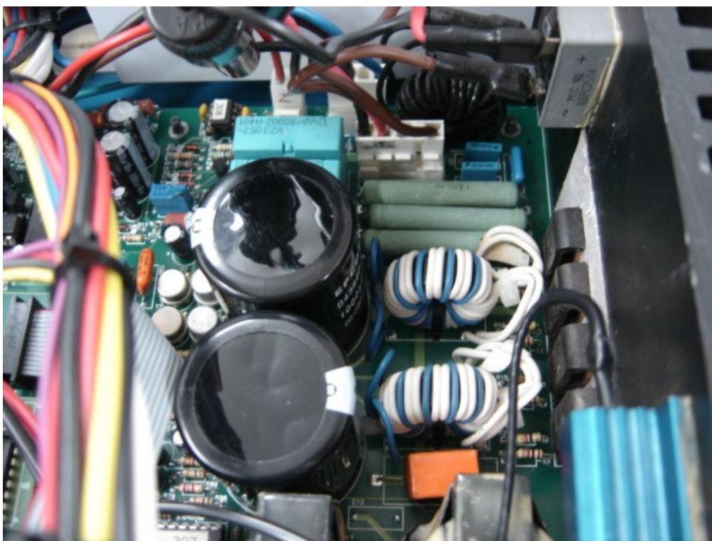
A.1 – Capacitores eletrolíticos, dentro de um bisturi eletrônico, que apresentaram problemas.
