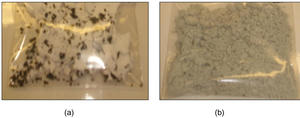
Figura 5.9. (a, b). Imagens da influência do tempo de sonificação na dispersão das nanofibras de polianilina. (a) 20 minutos e (b) 120 minutos.
