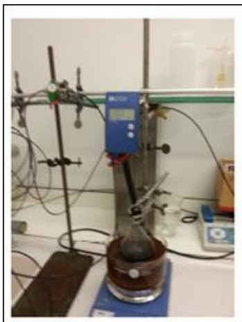
Figura 4.5. Reator de vidro utilizado nas reações de polimerização na Universidade de Mons, UMONS – Bélgica.
