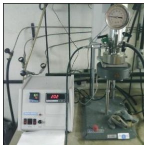
Figura 4.3. Reator PARR utilizado na síntese dos compósitos através da polimerização in situ .
