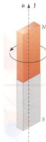
Figura 4 - Barra magnética em movimento para gerar um momento magnético
