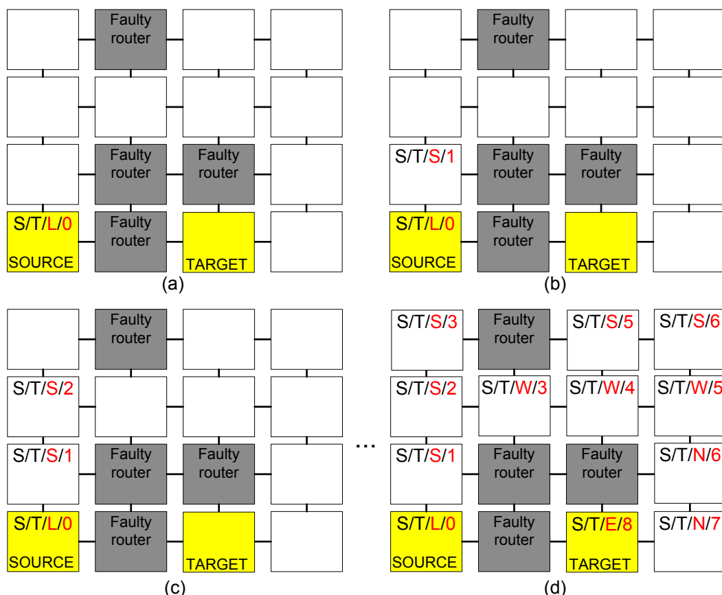
Figura 14 – Demonstração do método proposto por [WAC13] em uma NoC 4x4.
