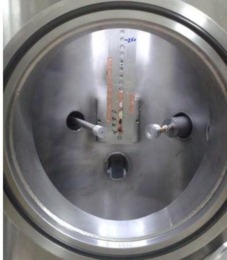
Figura 4.11. Interior da câmara do JET com as amostras, o detector de silício SDD (esquerda) e um detector de partículas (direita).
