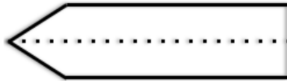
Figura 5.2. Imagem ilustrando com a linha pontilhada o local onde foi efetuada a análise longitudinal ao longo da direção do crescimento nos lingotes por EDS.
