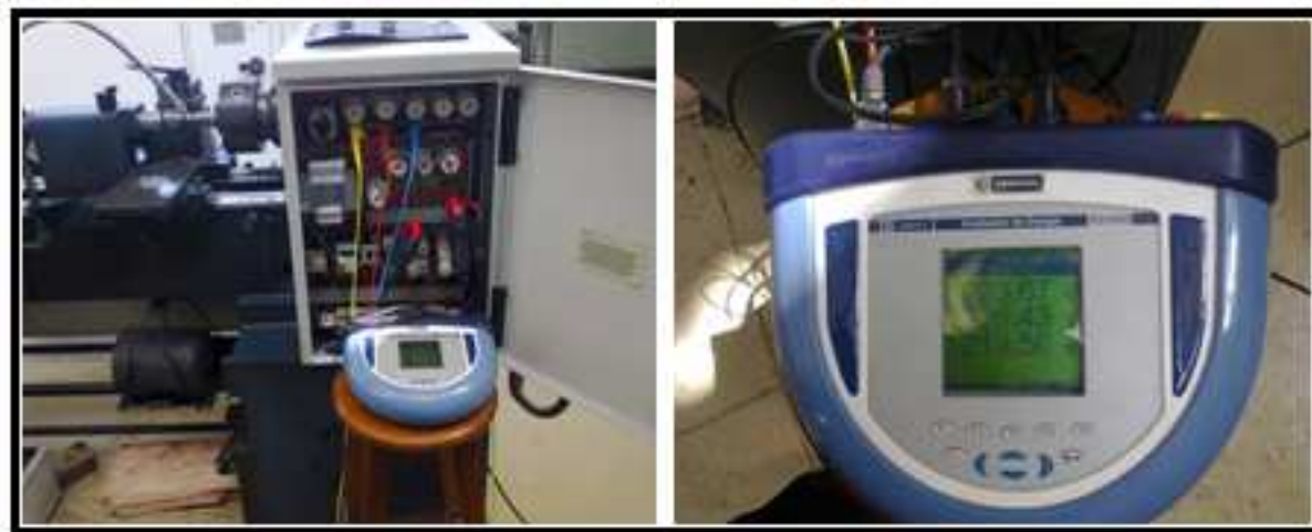
Figura 4.11. Tomada da tensão, correntes e potência ativa através de um analisador de forças.
