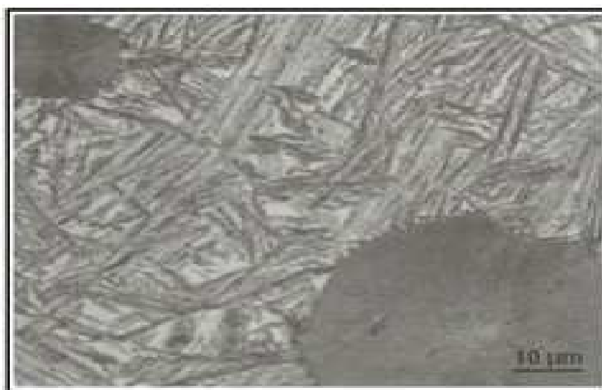
Figura 3.7. Microestrutura de ferro fundido austemperado consistindo de ferrita acicular numa matriz de austenita de alto carbono (ausferrita). Ampliação: 1000 X. Fonte: Guessser, 2009.
