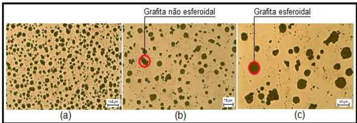
Figura 5.2. Corpo de prova bruto de fusão, sem ataque químico. Ampliação de 50 X (a), 100 X (b) e 200 X (c).
