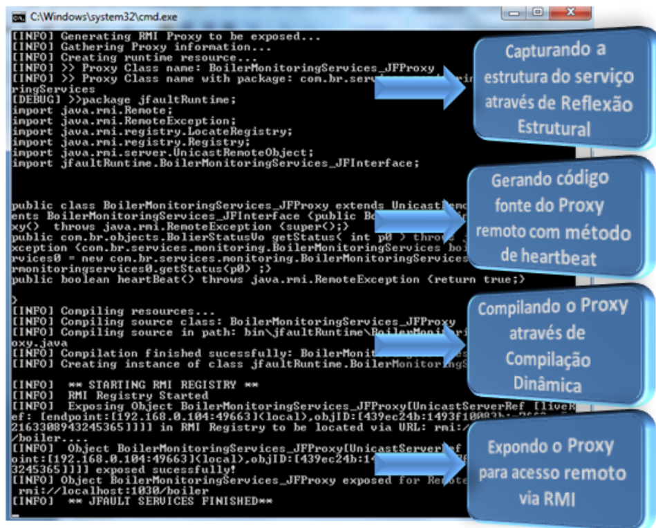
Figura 27 – JFaultManager: Inicialização do framework no servidor
