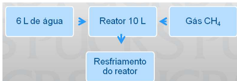
Figura 4.3 Fluxograma da síntese de hidrato de metano realizada no R01 (capacidade 10L).
