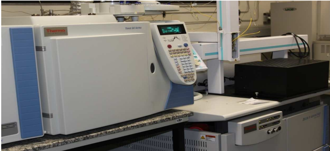
Figura 4.11 GC-IR-MS para análise de fracionamento isotópico.
