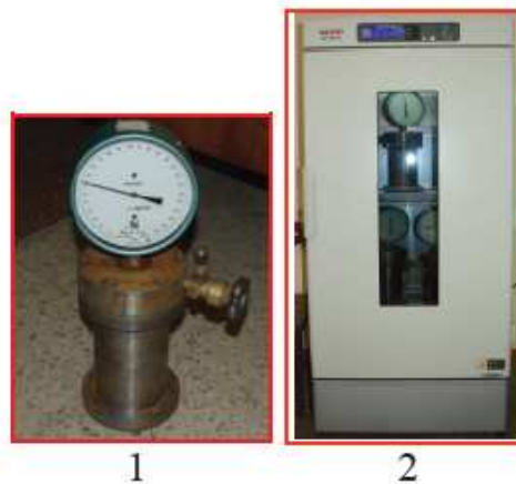
Figura 3.16 Em 1 uma câmara de aço a alta pressão, em 2 incubadora refrigerada. Fonte: Semenov e cols. (2011).
