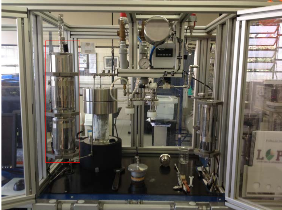
Figura 5.5 - Unidade SAS acoplada à planta piloto de extração supercrítica
