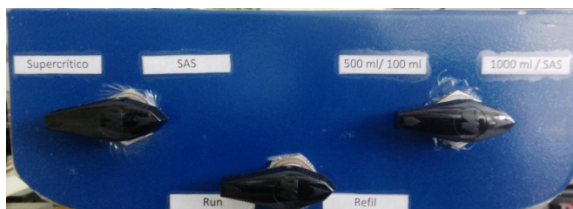
Válvula de três vias “RUN/REFIL” na posição “REFIL”
