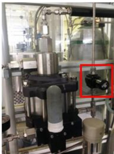
Bomba de deslocamento positivo; em destaque, válvula de entrada de ar comprimido.
