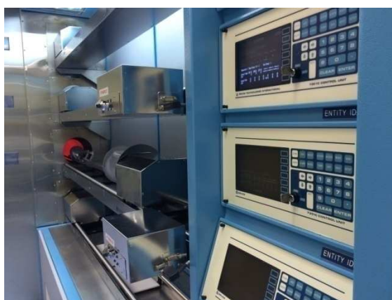
Figura 3.5. Forno utilizado na difusão de fósforo.
