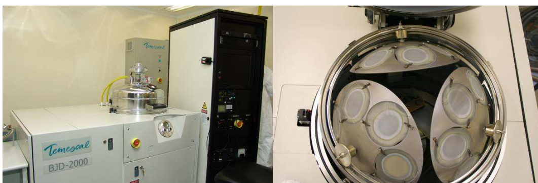
Figura 3.6. Sistema de evaporação da marca Temescal modelo BJD2000.
