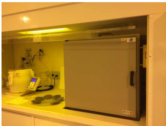
Figura 3.4. Spinner e estufa utilizada na deposição de boro por spin-on .
