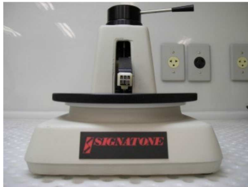
Figura 3.8. Equipamento “quatro pontas”, da Signatone para medidas de resistência de folha.
