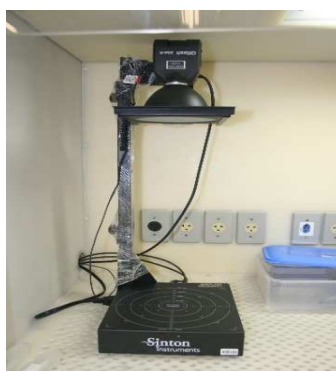
Figura 3.9. Equipamento para medição do tempo de vida: WCT-100, da Sinton Consulting.
