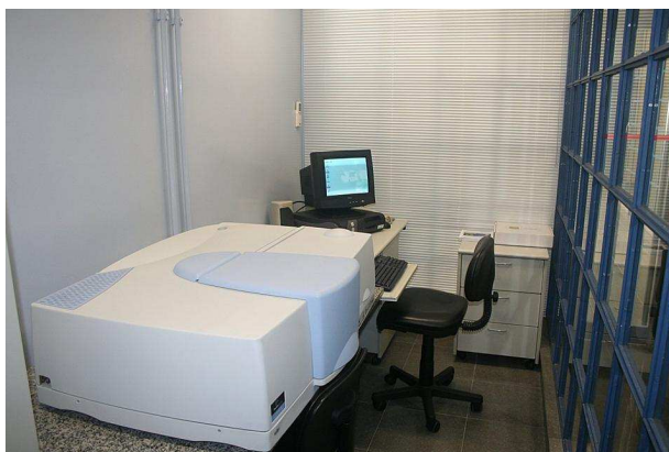
Figura 3.10. Espectrofotômetro Lambda 950 Perkin-Elmer® utilizado neste trabalho para medição das refletâncias.
