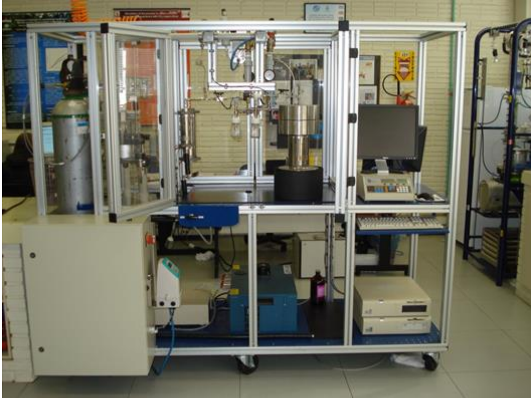
Figura 4.1. Unidade piloto de extração supercrítica.
