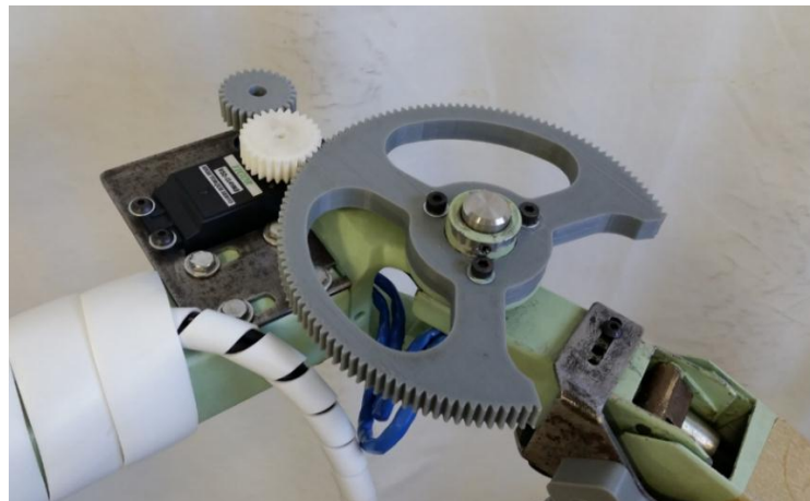
Figura 66 - Imagem da Junta 2 automatizada (componentes especificados na Figura 32)
