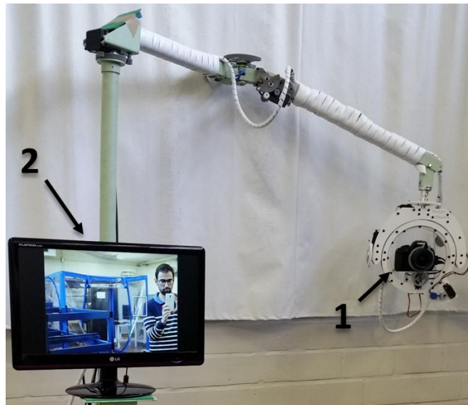
1) Câmera Canon EOS 600D transmitindo, por HDMI, o vídeo capturado em tempo real; 2) Monitor LCD LG exibindo as imagens transmitidas pela câmera.
