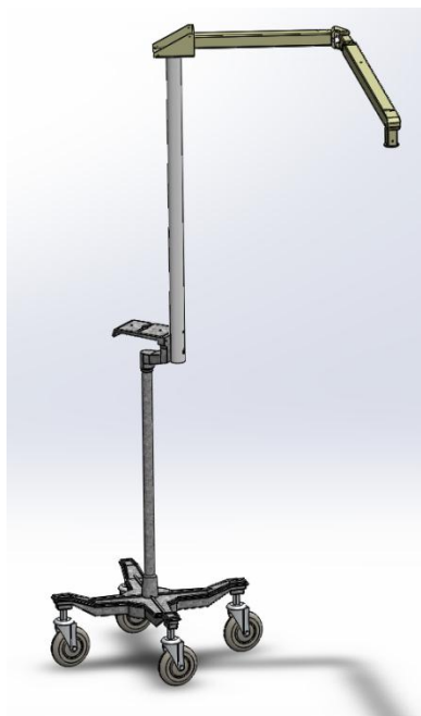
Figura 23 – Imagem 3D da estrutura mecânica do eSurg-Arm, gerada no software SolidWorks®, ilustrado a base móvel e o suporte articulado.
