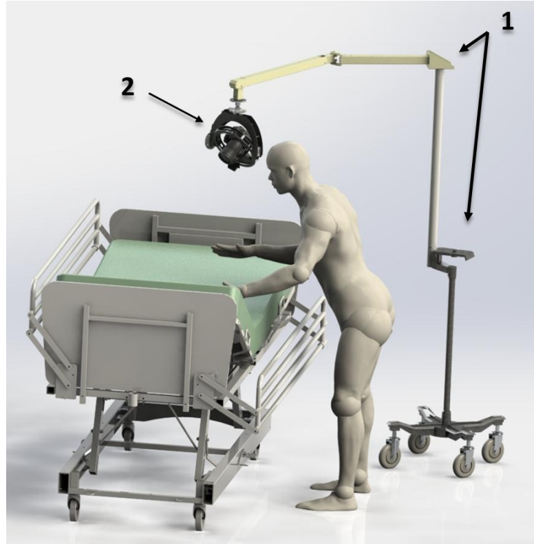
Figura 59 - Imagem 3D da estrutura mecânica do eSurg-Arm
