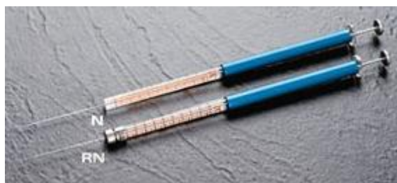
Figura 9 - Microseringas utilizadas para coleta e injeção de amostras gasosas.
