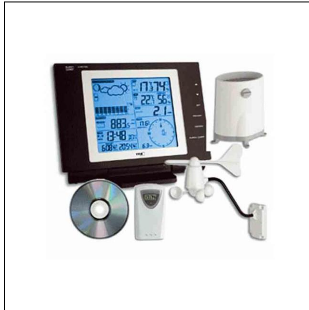
Figura 17 - Estação metereológica Nexus TFA
