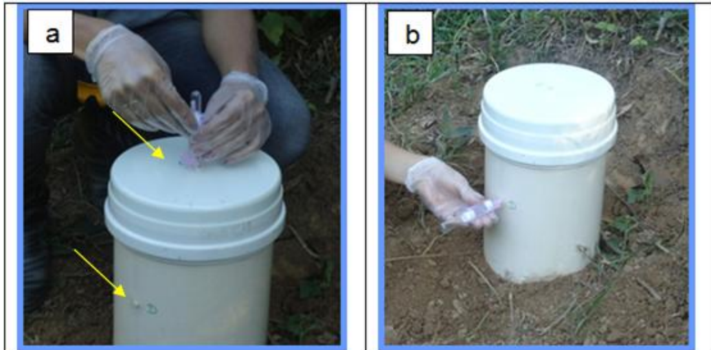
Figura 14 - Campânula projetada para o acúmulo de gases emanados do solo.
