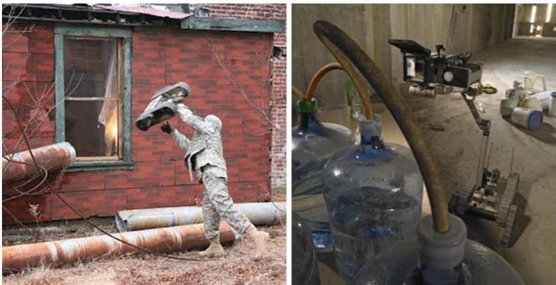
Figura 4 – Soldado arremessa um PackBot por uma janela, para que suas câmeras de vídeo permitam a visão de dentro do recinto e entrada segura.
