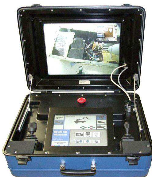
Figura 7 – Estação de controle do VTNT GUARDIAN 3 , utilizado em operações de destruição de material explosivo.
