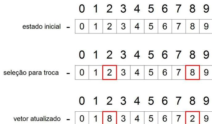
Figura 5.2 - Exemplo de troca com a vetor de ponteiros
