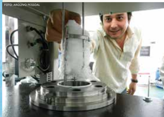
Ketzer observa hidrato de gás durante os testes da planta-piloto na Espanha
