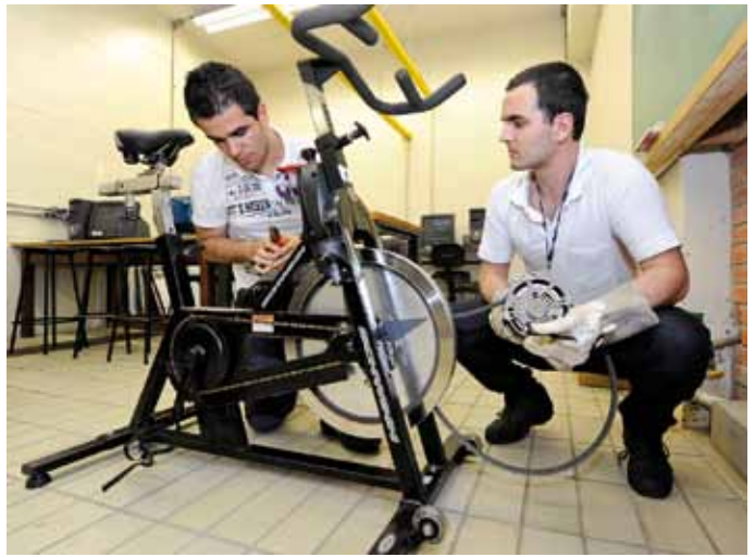
Ávila (E) e Andrade e o protótipo para converter energia mecânica em elétrica em bicicletas ergométricas
