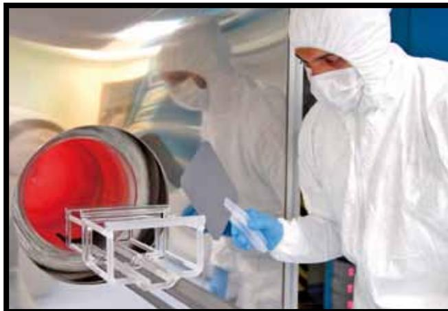
Difusões de fósforo em lâminas de silício se transformam em células solares
