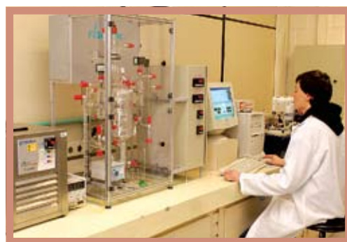
Ebuliômetro: preciso e com resultado imediato
