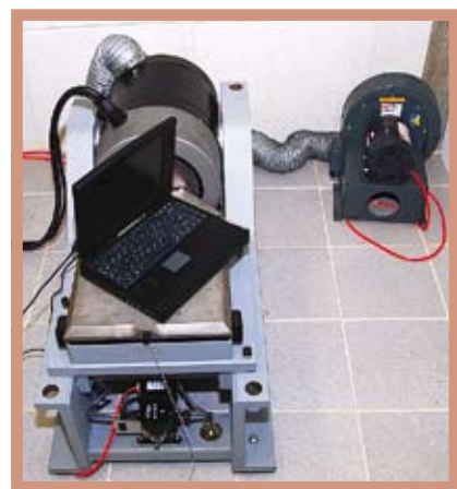
Ensaio de vibração em eletroeletrônicos
