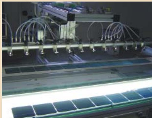
Prensa para fabricação de placas fotovoltaicas
