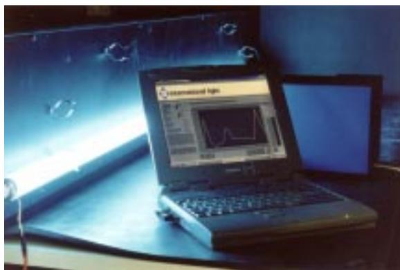
Câmara de teste: medida da irradiância espectral
