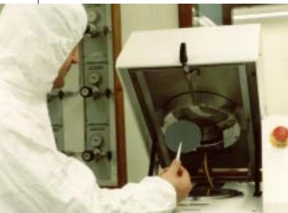
Forno para fabricar células solares
