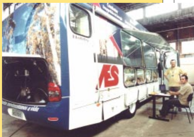
Veículo utiliza células fotovoltaicas e energia eólica
