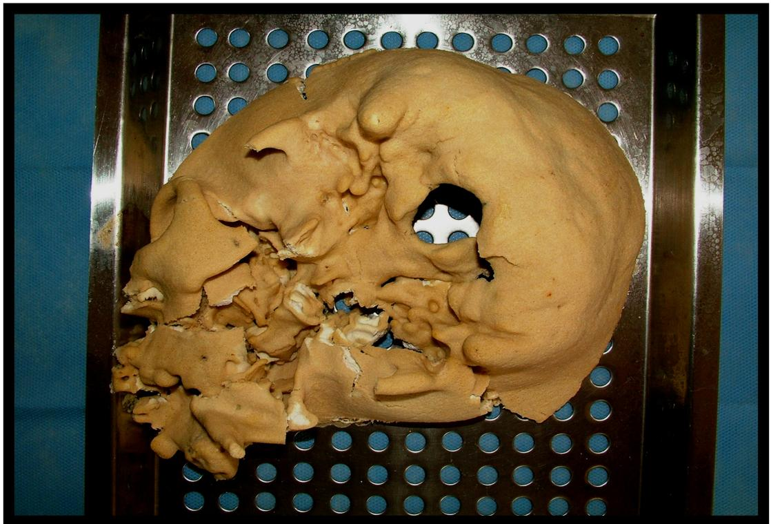
Figura 5 - Modelo 3DP™ após esterilização em autoclave.
