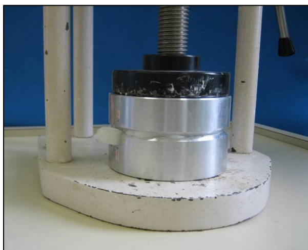
Figuras 3: Matriz fechada sendo prensada para o extravasamento dos excessos de resina.
