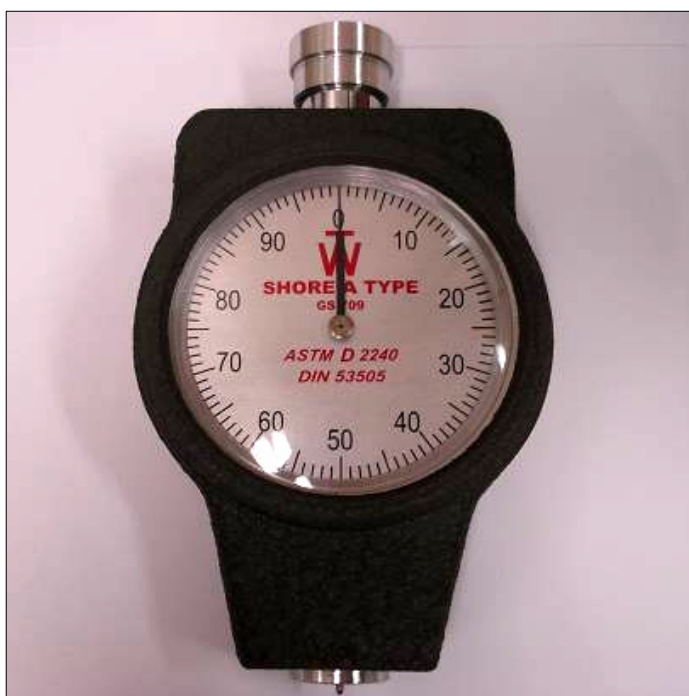
Figura 9: Durômetro Teclok Shore A (Woltest - Metaltest Indústria e Comércio Ltda, São Paulo, SP, Brasil).
