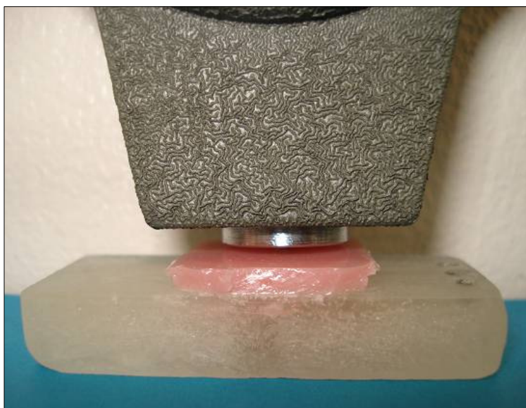
Figura 10: Penetrador do durômetro mensurando a Dureza Shore A.
