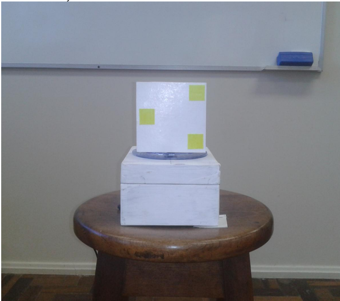
Figura 4.1.1 - Dispositivo simulador de movimentos angulares com a configuração para o teste de movimentos yaw
