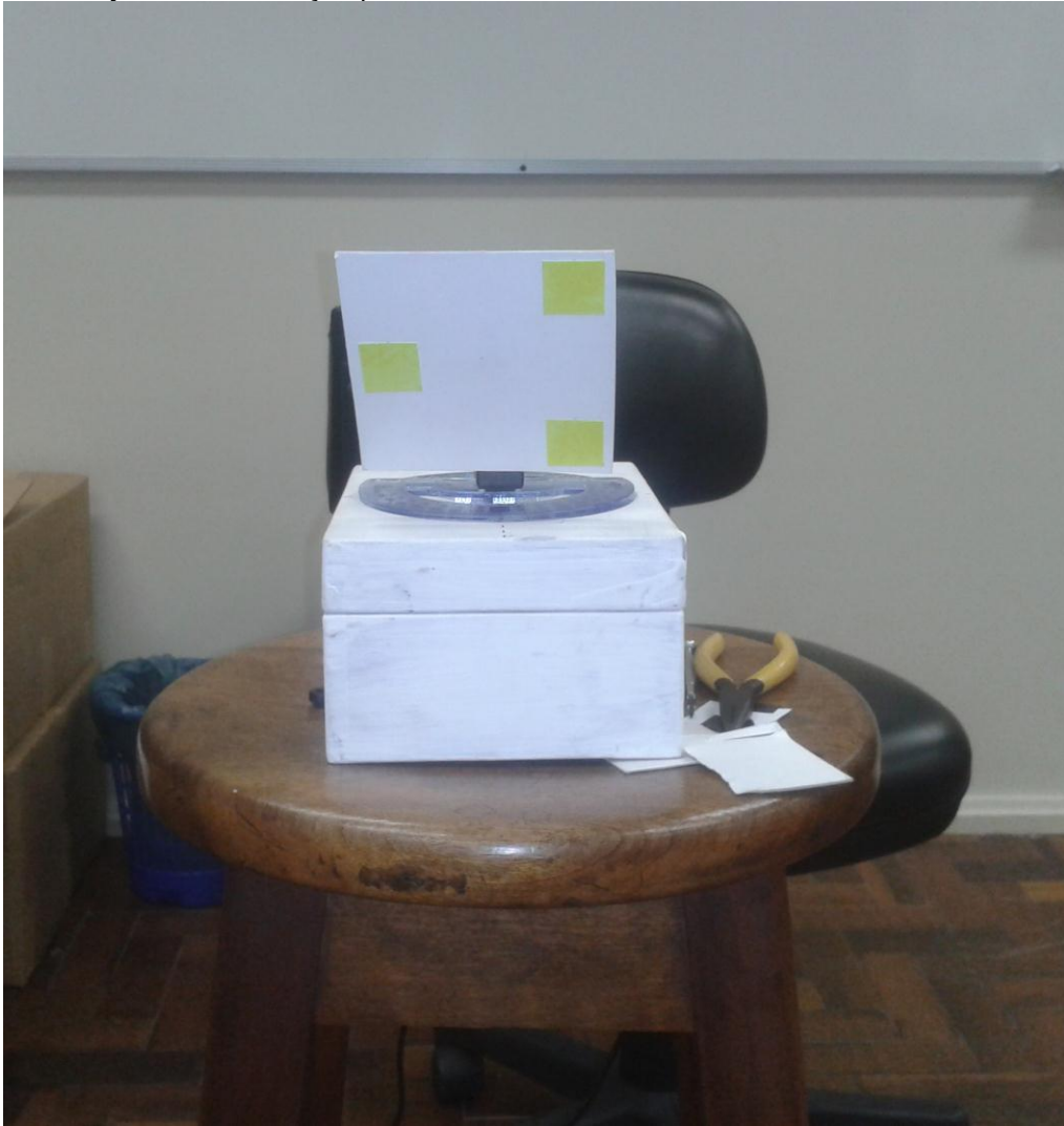
Figura 4.4.1 - Dispositivo simulador de movimentos angulares com a configuração do teste para movimento yaw com inclinação pitch de 30°.
