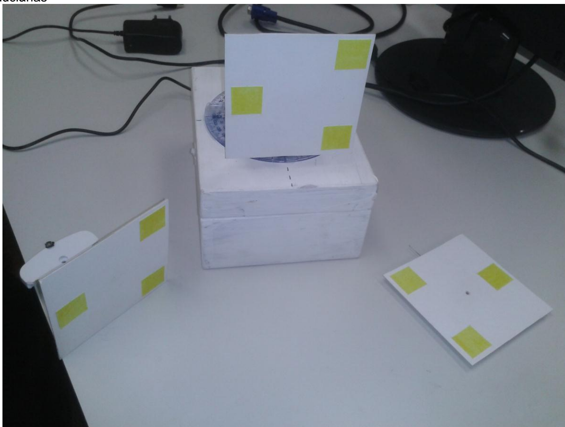
Figura 3.6.4: Dispositivo simulador com acessórios para fixação das placas com as marcas fiduciárias
