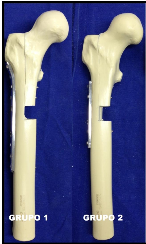
Figura 7 – modelos ósseos do fêmur proximal após a realização da osteotomia em "L" divididos em dois grupos de acordo com a fixação.
