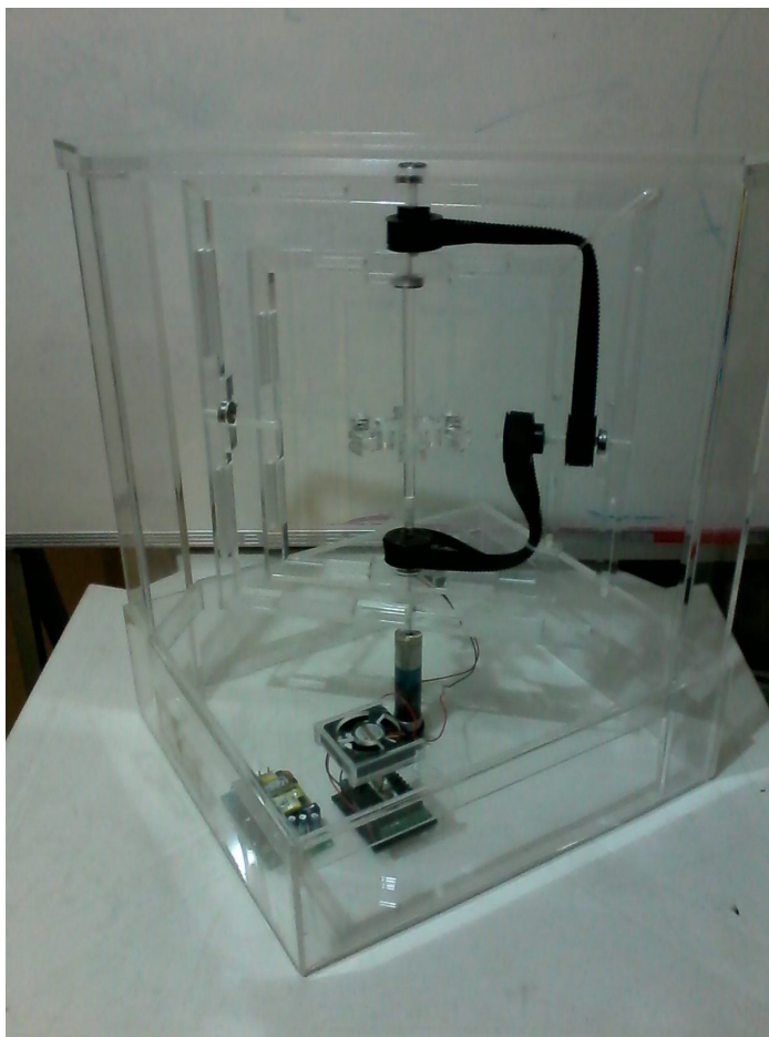
Figura 53 - Imagem do protótipo do clinostato tridimensional de três eixos em construção.
