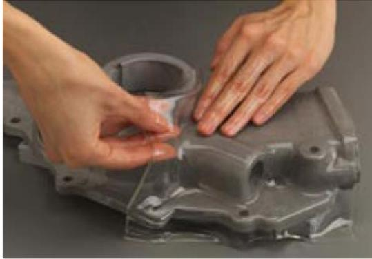
Figura 3.3. Aplicação da película para fotoelasticidade por reflexão (Vishay Precision Group).
