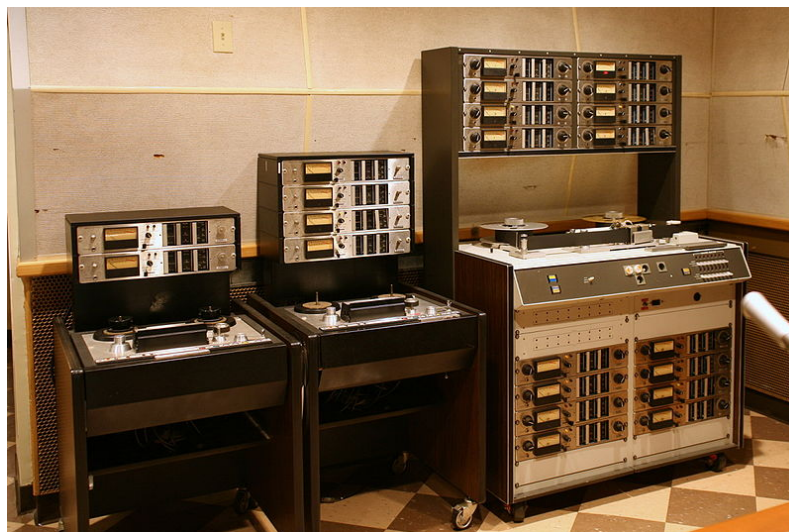
Figura 9 – Três tipos de gravadores utilizados em estúdio de gravação. Da esquerda para direita: Ampex AG-440-2 – 2 canais e fita de ¼ de polegada; AG-440-4 – 4 canais e fita de ¼ de polegada; Ampex MM1000 – 16 canais e fita de 2 polegadas
