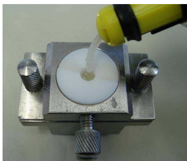
Figura 14: Inserção do cimento resinoso no interior da matriz bipartida de PTFE (teflon)
