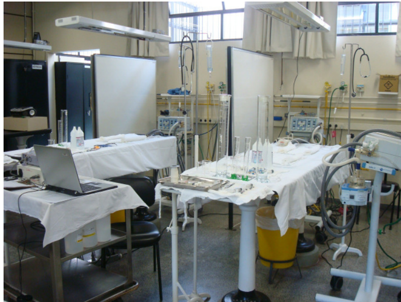
Figura 2 - Laboratório de Cirurgia Experimental organizado para o experimento. Observar os ventiladores Inter 5, o pneumotacógrafo conectado ao computador, os oxímetros de pulso e todo o material necessário para o experimento.
