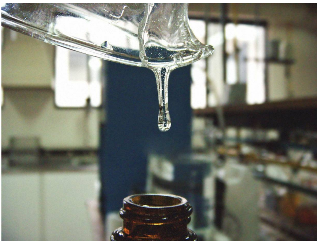
Figura 3: HPMC após sua síntese com silano (HPMC-Si). Verifica-se o aspecto viscoso do hidrogel antes de sua reticulação.
